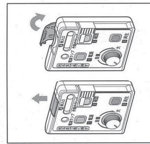
**③** 音声メモリーを袋から取り出す。ICプレーヤー表面が見えるようにした状態で、矢印の面を裏にして、奥に突き当たるまでしっかりと差し込む。
