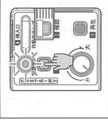
**⑦** ICプレーヤー右側の「スライドカバー」を下方向に移動させる。
