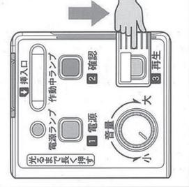
イヤホンの左右を確認してから、耳に付け、②の「確認ボタン」を、「作動中ランプ」が光るまで長く押し続ける。
